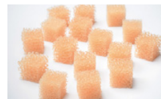
排水処理方法の一つである接触酸化法（微生物処理）で、有機物を分解する微生物を多く付着させるために比表面積を大きく設計した流動担体
