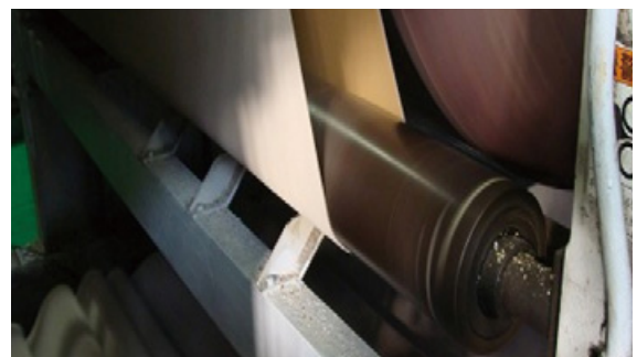
[対策前]紙ロールの挟まれ危険箇所
