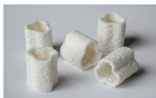
排水処理方法の一つである接触酸化法（微生物処理）で、有機物を分解する微生物を多く付着させるために比表面積を大きく設計した流動担体
