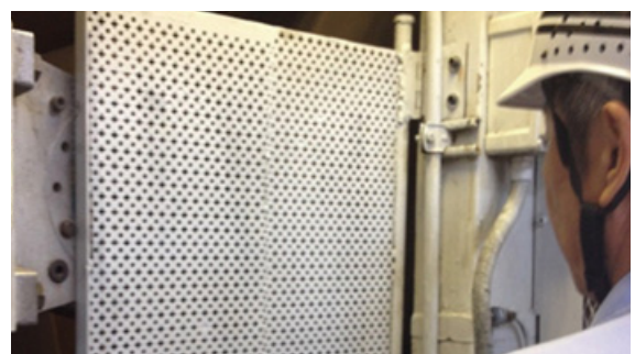
[対策後]安全カバーの設置
