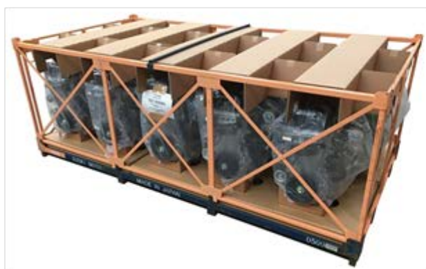
汎用リターナブルラックと段ボールによる包装
