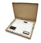
業務用無給水加湿ユニット「うるるユニット」用パネルという平らな製品のオール段ボール包装を設計開発した。貼り加工の不要な緩衝材と、テレスコープ形 (0300) の外装箱とを組み合わせ、緩衝材は組立・製品へのセットも容易なものを 4 コーナーに配置した。前後左右上下の 6 方向を効果的に緩衝保護でき、1 種類に共通化も実現。製品保管段積数も 20 段を実現した。
