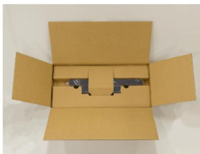
一般顧客向けバッテリー交換用の往復箱の設計を行った。全国へ発送(空輸・船便含む)できる梱包仕様、再梱包の容易さも考慮した。バッテリーサイズが荷札より小さく、形状が左右非対称のため、巾を確保しつつ固定でき、容易に梱包・返送できる緩衝材の仕様とし、ペロの差し込みだけで開梱・再梱包可能とした。外箱は荷札が貼れる最小サイズとした。
