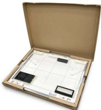
業務用無給水加湿ユニット「うるるユニット」用パネルという平らな製品のオール段ボール包装を設計開発した。貼り加工の不要な緩衝材と、テレスコープ形(0300)の外装箱とを組み合わせ、緩衝材は組立・製品へのセットも容易なものを4コーナーに配置した。前後左右上下の6方向を効果的に緩衝保護でき、1種類に共通化も実現。製品保管段積数も20段を実現した。
