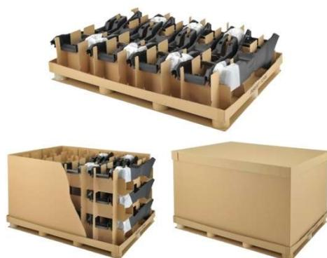
輸出向け自動車用コンソールボックスは、1ケースに24個収納して輸出していたが、1製品ごとに発泡PSとPE保護シートを使用しており、資材コストと梱包作業に課題があった。そこで製品を交互に並べ、表に出ない製品の内側で固定することで、変形・擦れ・接触を防ぎ、さらにプラスチック材料の使用を大幅に削減し、資材点数、包装体積も削減した。
