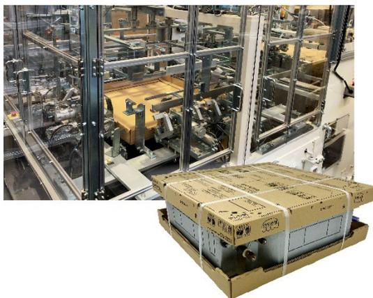
業務用の天井埋込カセット形エアコンは段ボール製トレイで上下から梱包され、この梱包用トレイは大型で複雑な構造な為、人が手で組立てていました。そこで自動組立可能なトレイ形状とそれに対応した自動組立機械構造を開発いたしました。この自動組立機械構造は包装機械業界初でトレイサイズも最大級となります。
