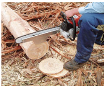
写真2 材質を調べるため円盤を採取する
