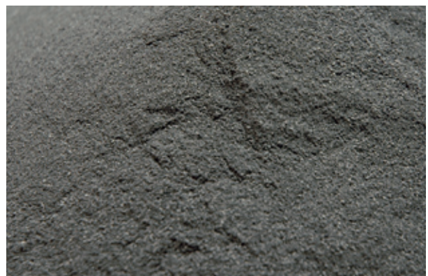
焼却後のPS灰。セメント原料、土壌改良材として有効利用しています。
