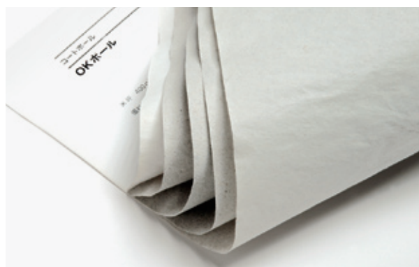
段ボール原紙や白板紙は、多層構造の厚紙。各層で異なるグレードの古紙を利用しています。
