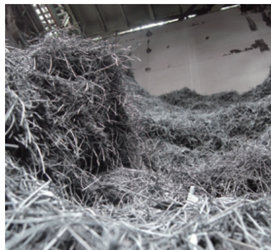
廃タイヤに含まれるワイヤー。配管詰まりなどの作業トラブルになることが多い。
