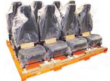
王子コンテナーが開発した段ボール製の海外向け自動車用座席輸送固定材
