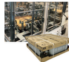
ダイキン工業株式会社様と協業して開発した大型業務用エアコン室内機の梱包用トレイと自動組立機
