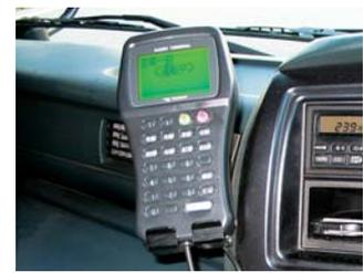
写真2 走行情報を収集するため全保有車両に設置したデジタルタコグラフ
