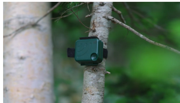
鳴き声の 音声解析センサー
