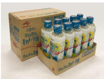
輸送・保管用途に加え、開封後そのまま店頭等で陳列トレイとしても使用できるSRPを導入。指で簡単且つきれいに開封できる、陳列トレイとしてそのまま棚に設置できる、という特性から、お客様の店頭での品出しや陳列作業の負荷軽減・時間短縮につながる事が期待される。また、SRPの課題の一つとして、箱側面の開封部（ミシン目）が膨らみ、積載時の荷崩れ・製品破損等の原因となることが挙げられるが、上部からの荷重を分散させる独自形状を採用し、課題解決の一助となっている。
