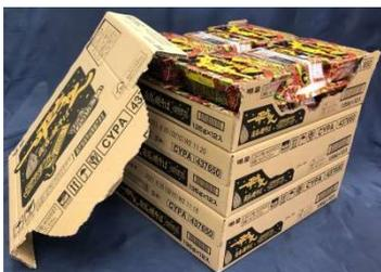
店頭での品出しや陳列時の省力化と、環境負荷低減の両立を目的とした「カップ焼きそば」用段ボールケースの開発を行った。従来の開封用カッターテープを廃止し、開封用ジッパーを追加することで開封作業時間を1/4に、さらにカップの配置をハーフオポジション方式として余剰空間を減らし、段ボール使用量と箱容積をそれぞれ約10%削減した。
