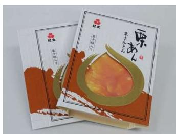
おせち商品トレイ用のスリーブ。スリーブ組み立て時の四隅下部に切れ込みを入れて、トレイを差し込んだ後ロックがかかるように設計した。栗を形どった穴をあけたことにより、スリーブをはめた状態でも中身を確認できるようにした。また、裏面にクリーム色のノーコートボールを使い、スリーブの内側もまるで栗あんのような色が見えるようにするとともに、穴の周りには金箔押しと空押し(デボス)をしており、商品の高級感とデザイン性、広告効果を狙った。
