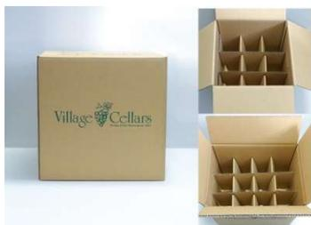
輸入ワインの販売における輸送では、瓶径の異なる商品を同一包装で輸送するため破損事故もあり、その改善が課題だった。従来は最大瓶径に合わせ、高さも箱高さと同じ組仕切りを使っていたため、小径の商品は、組仕切りの中で暴れていた。そこで組仕切りに緩衝機能を持たせて小瓶も保護し、12本入りと9本入りを兼用して材料を削減、作業性も損わず課題を解決した。
