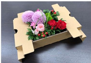
京都発祥で主に宇治茶・抹茶スイーツを販売する伊藤久右衛門では、花とお菓子を同梱するギフトセットを開発した。花は四角い花器に生けられたアレンジメントで、花器全体を覆い尽くすデザインとなっているため、花を傷めずに花器の固定ができる包装資材が求められた。1枚で構成されるパットを組み立てていくと、内側から花器を固定するための固定爪が出現し、花器上面を側面から固定する。資材の組立は差込みと折り返しからなるテーブル構造で、花器固定部分を外側に引っ張ることによって、簡単に花器の梱包及び開梱作業がおこなえる。
