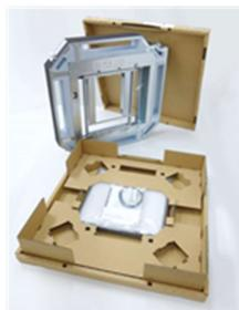
業務用天井埋込エアコン室内機に取付ける「ストリーマ除菌ユニット」の梱包を環境対応のため、オール段ボール化と作業性改善を目指した。保護機能を維持しつつ段ボール化により部材点数を2/3に削減、前後2分割パッドと固定用段ボールにより、作業工数を約17%削減。さらに各部材の組立てを簡素化し、段ボール使用量を重量比約13%削減した。
