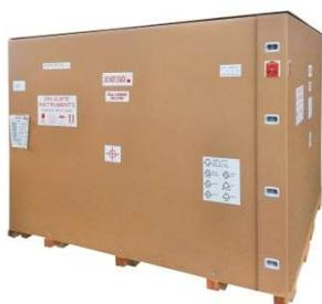
チップマウンターは重量が約2トン。従来のスチールパレットと重量物用段ボールの梱包は、コスト・作業性などに課題があり、改善を行った。スリーブのジョイントにはパナジョイントを、さらに上蓋はカットシートをエムネジで固定した結果、作業性・保管性が向上し、年間1,590万円のコストダウンを実現した。
