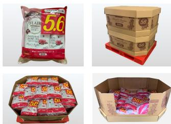
会員制倉庫型店など大規模店舗向けに省作業・省資源・販促性に優れた大型SRPを開発した。集積袋にエアを封入して緩衝性と耐圧性を持たせ、SRP内に横倒しで積重ねる収納形態により、セットおよび店頭作業性を大幅に改善。組立て作業時間80%、店頭の段ボール回収時間90%、包材使用量71%、CO<sub>2</sub>排出量45%、積載効率67%それぞれ改善した。
